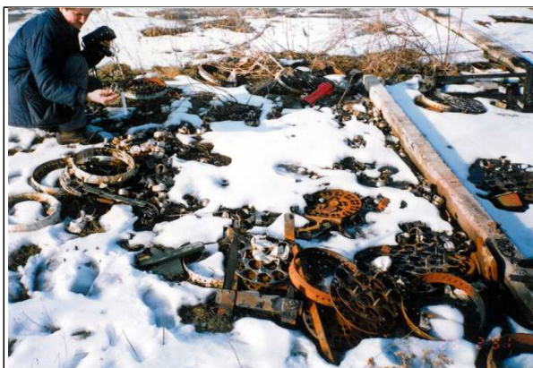
Sármelléki reptér rakéta alkatrészek sugárzás mérése
